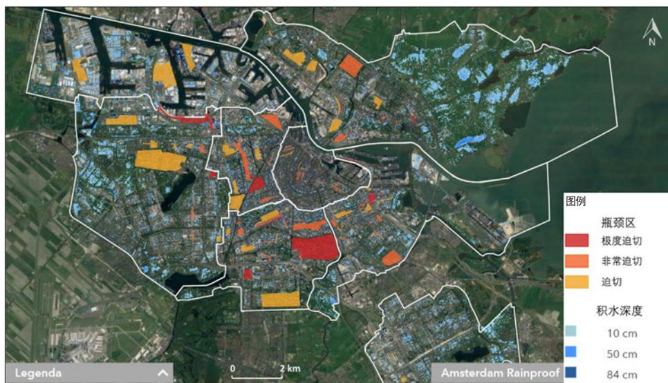
图5 发生2 h 120 mm降水时积水点模拟结果及瓶颈区分析
