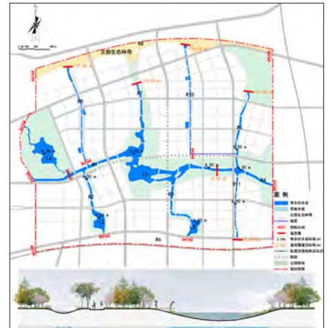
图11 常水位水系布局与风貌示意图
